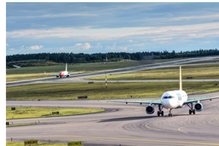
Ett flygplan med ett visst ACR får bara trafikera en flygplats som har ett PCR som klarar flygplanets ACR. Det är ett sätt att se till att inte för tunga flygplan trafikerar flygplatser med banor med för låg bärighet.
