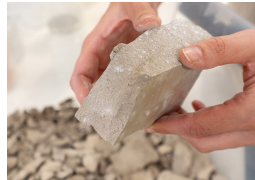
Block med rengjord återvinningsmassa.
