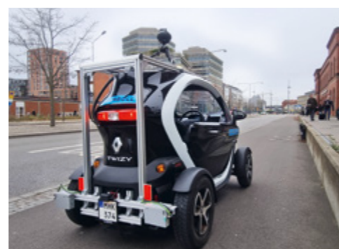
RST Velo är en flexibel insamlingsplattform för cykelvägar framtagen av Ramboll RST. Med hjälp av lasersensorer mäter den vägens jämnhet.
