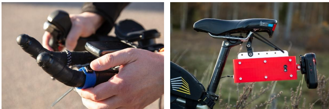
Tryckknappen på styret (vänster) och TrafficLogger-boxen som fästs i sadelrälsen (höger).
