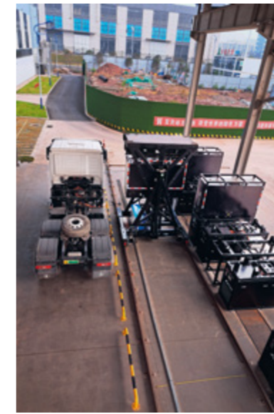
Demonstration av batteribytestystem på företaget Zhi Li Wu Lian i Yibin.
