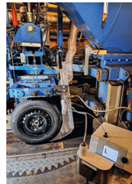
Hjulupphängningen med personbilsdäck och den nya utrustningen för partikelmätning på plats.
